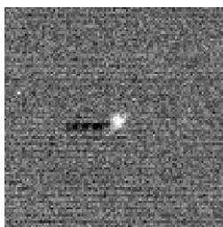
Рис. 2 Типичный снимок регистрации КО, находящегося в тени Земли
