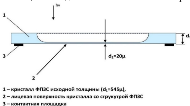
Рис. 1. Поперечное сечение кристаллов ФППЗ, утоненных только в фоточувствительной зоне.
