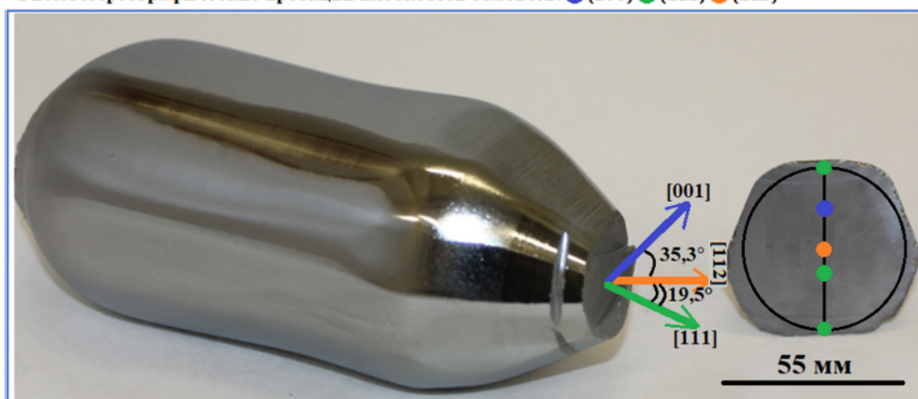
Рис. 1. Разметка слитка под резку, исходя из положения гномостереографических проекций соответствующих плоскостей [2]
