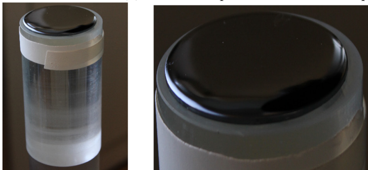
Рис. 3. Монокристалл твёрдого раствора КЦТ, выращенный в результате 70 часового процесса
